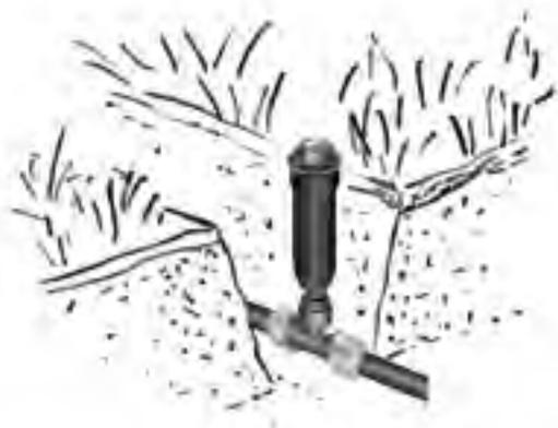
**G** Jetzt platzierst Du die Leitungen mit Anschlussstücken und Regnern im Graben. Alle Regner und Düsen müssen bündig zur Erdoberfläche installiert werden. Der Düsenkopf inklusive Griffmulden sollte sich zur regelmäßigen Reinigung oberhalb der Erdoberfläche befinden.
