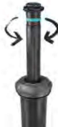
**C** Verbinde jetzt die Elemente. Schiebe die Rohre ca. 6 cm in das Verbindungsteil über den O-Ring. So entsteht eine wasserdichte Verbindung. Vorsicht: Nach ca. 4 cm kommt ein Dichtungsring. Bitte das Rohr an dieser Stelle noch weiter in die Öffnung einführen.
